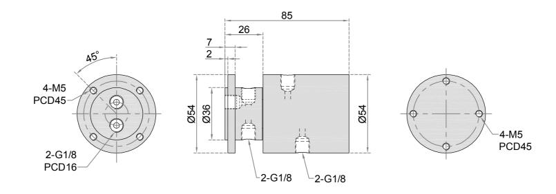
技术参数: 最高转速:300RPM 最高温度:125°C 最大压力:10BAR 介质: 气 真空
